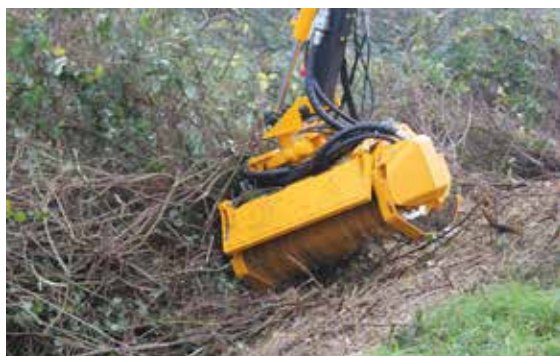
Een sterke motorkap en een (gesloten) hydraulisch opklapbare voorzijde.
