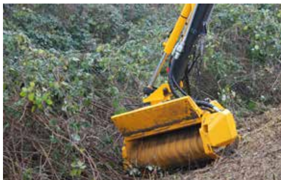
Hier getoond met een geopende hydraulisch opklapbare voorzijde zodat hoger struikgewas beter ingevoerd kan worden.
