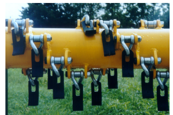
40x12 klepel. Deze klepel is geschikt voor het maaien van gras.
