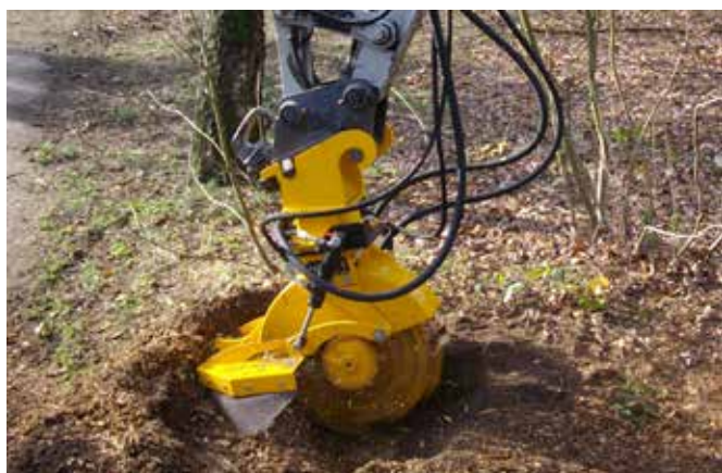
Hydraulicznie regulowana klapa ochronna, SCE-410H (opcjonalnie)
