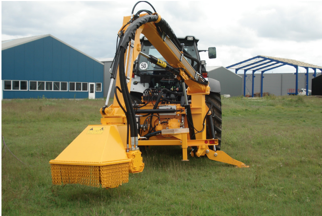
Hydraulische aandrijving van de SC-900H
