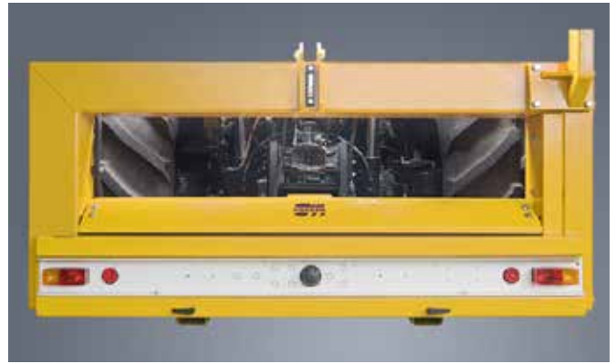
Der Spezialtankbock beim Hydrauliktank sorgt dafür, dass der Zughaken für einen Anhänger zugänglich bleibt.
