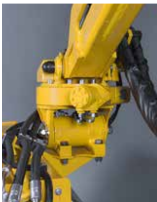
Stabilisierungszylinder vor gefederter Vorderachse erhöht die Stabilität.
