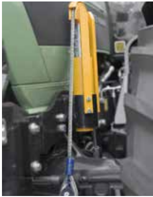
Stabilisierungszylinder vor gefederter Vorderachse erhöht die Stabilität.
