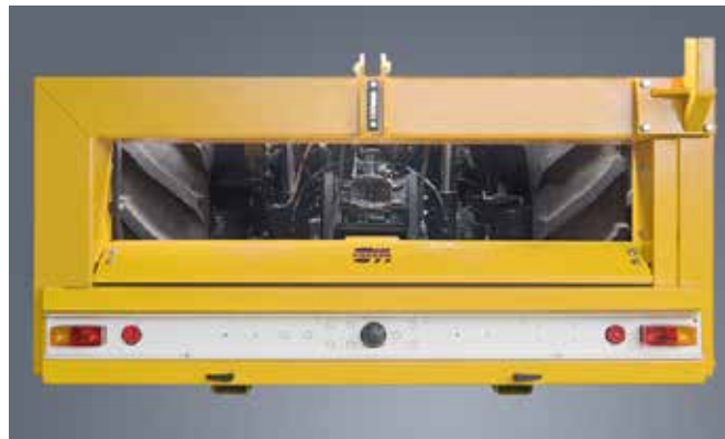
Speciale tankbok bij de hydrauliektank zorgt ervoor dat de boventrekhaak toegankelijk blijft voor een aanhangwagen.
