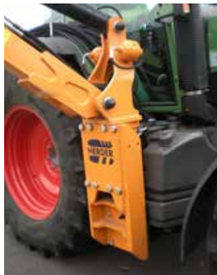
Draaikolom 'draaicilinder' voor smalle aanbouw.
