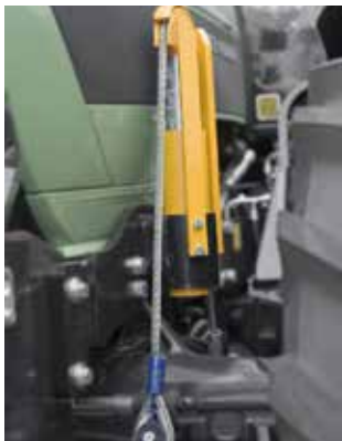
Stabilisatiecilinder voor geveerde vooras verhoogt de stabiliteit.
