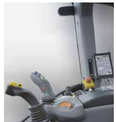
De joystick zorgt voor nauwkeurige bediening van de gieken. Nivotronic zorgt tijdens het maaien voor bodemvolgning.
