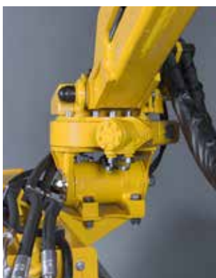
Stabilisatiecilinder voor geveerde vooras verhoogt de stabiliteit.
