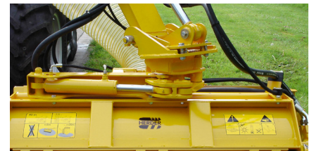
Hydraulischer Drehkopf 180° mittels Zylinder (HD180).
