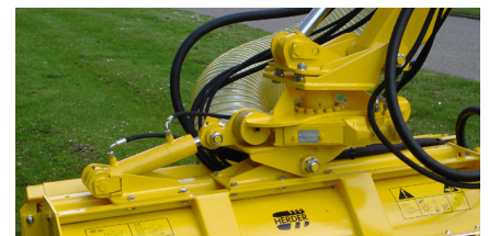
Hydraulischer Drehkopf 180° mittels Schneckenrad-Drehkranz mit hydraulischem Gelenklager (HWHP180).
