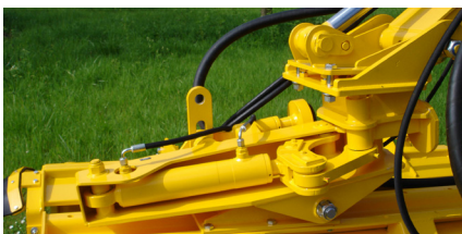
Hydraulischer Drehkopf 180° mittels Zylinder mit mechanischem Pendel (HDP180).
