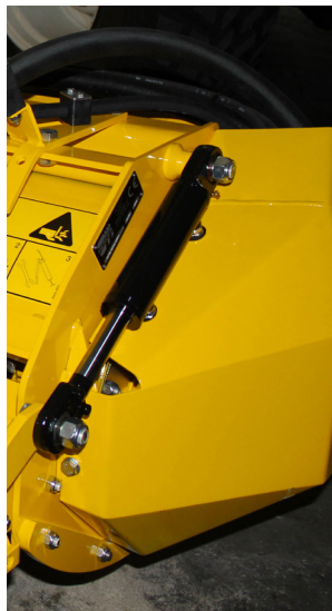
Optionaler Motorschutz und optionale hydraulisch hochklappbare Vorderseite zur besseren Zufuhr von hohem Mähgut.
