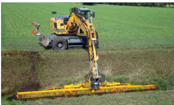
Meer bereiken in minder tijd met een maaikorf met een werkbreedte van 8,60 meter.
