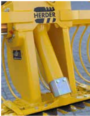
Onderhoudsarme meskop-verbinding met standaard lange mesbevestiging.
