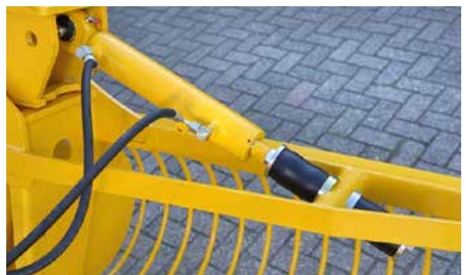
Met een optionele kantelcilinder realiseert u een transportstand binnen de 3 meter (de maximaal toegestane breedte) bij de 4,3 en 5,5 meter maaikorf.
