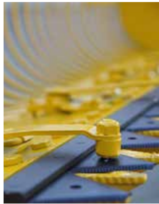
De messenbalk met verende drukker voor continue mesdruk.
