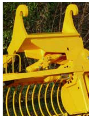
De maaikorf kan naar behoefte uitgevoerd worden met een Herder of een kraanaansluiting.
