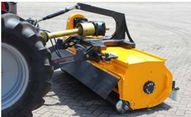
Der Sideshift kann bis 70 cm herausgeschoben werden.
